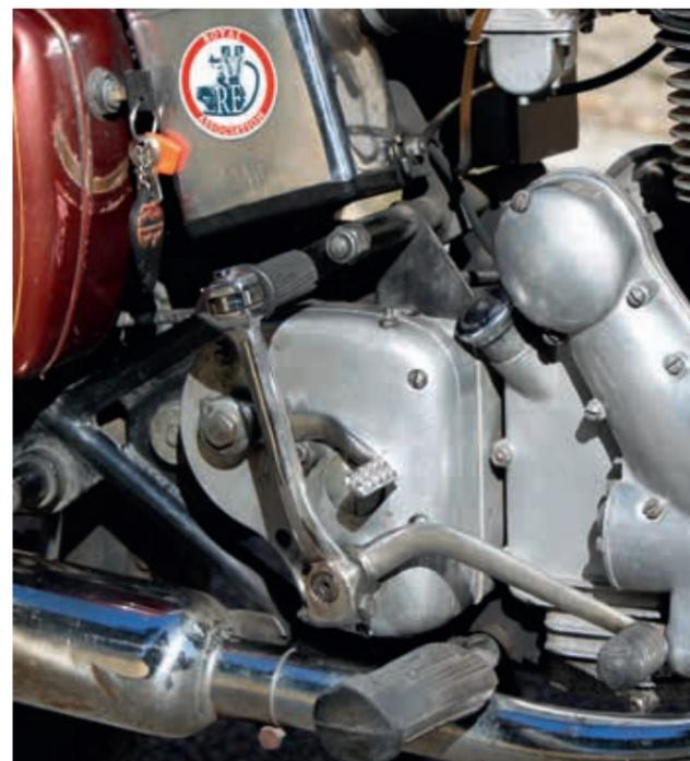
La boîte de vitesses séparée du carter moteur principal. En sortent l'arbre de kick concentrique au sélecteur de vitesses et le caractéristique cliquet de remise au point mort.
