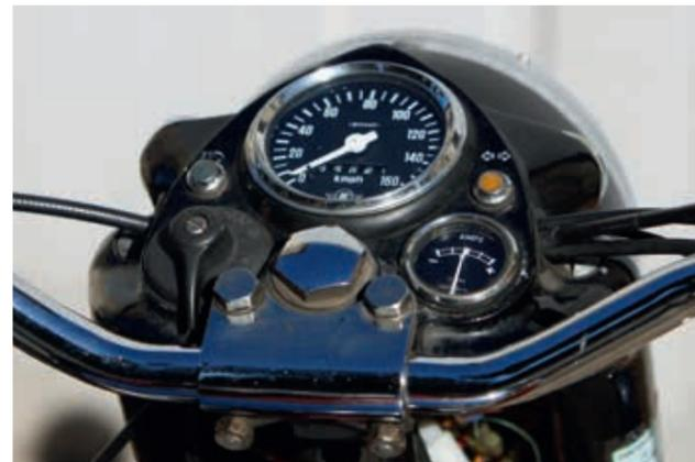
Sur ce modèle 1992, le tableau de bord est incrusté dans la nacelle de phare. L'interrupteur en bakélite (à gauche) de commande de l'éclairage est quasi inchangé depuis 1950...
