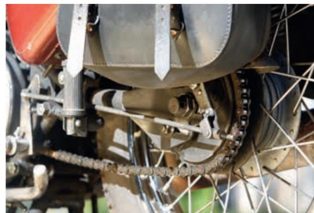
Notez que la partie tournante du frein à tambour supporte la couronne arrière. Pas terrible pour les projections de graisse, mais pratique au moment de démonter la roue.
